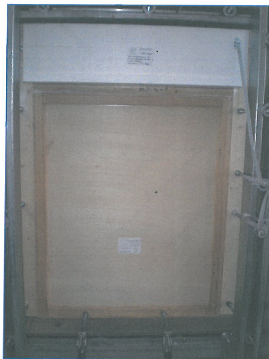
Struttura di prova con cassonetto ad ispezione da sotto
