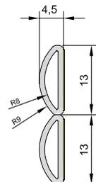
**CARATTERISTICHE:** Doppia guarnizione tubolare adesiva perimetrale per telaio e porta.
