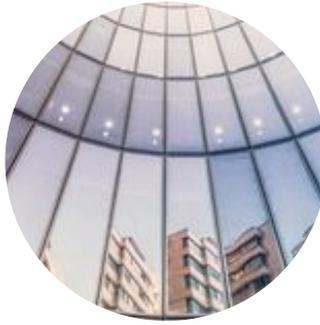
La pellicola Alu 80 C riduce significativamente il calore solare, pur mantenendo gran parte della luce naturale. Essa consente una buona riduzione dell'abbagliamento, e il suo aspetto specchiato garantisce privacy da sguardi indiscreti, consentendo un tocco moderno per l'esterno di un edificio.
